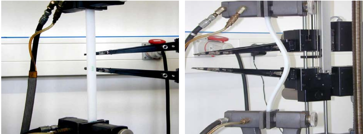
Bild B8 PE-Probekörper (4. Eulerfall) in der UMTS-Prüfmaschine, vor und nach Erreichen der kritischen Prüfzeit
