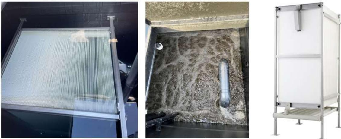
Abbildung 1: Versuchsanlage und Membranmodul
