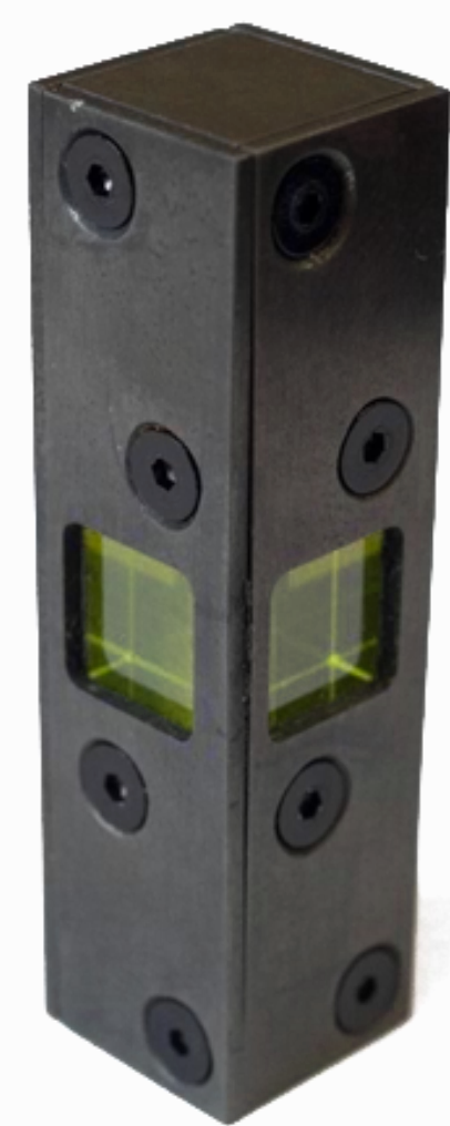
Fig. 1 Foto eines Einkristalls und eines daraus gefertigten Referenzstandards
