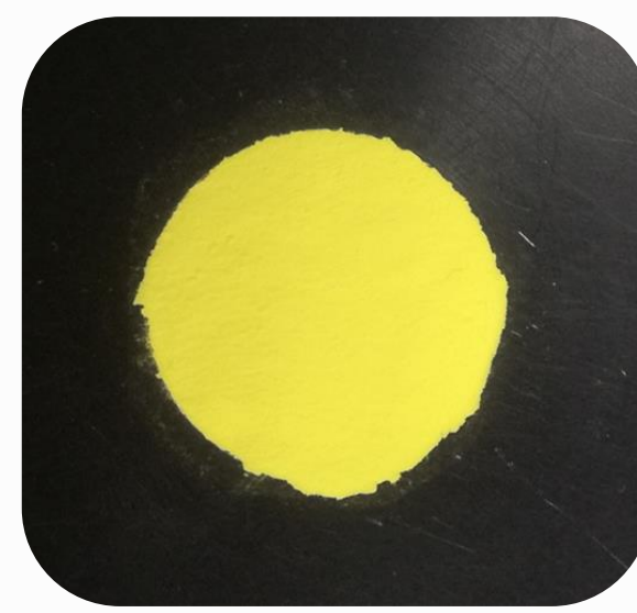
Fig. 2 YAG:Ce 3+ Pulver in einem Probenträger
