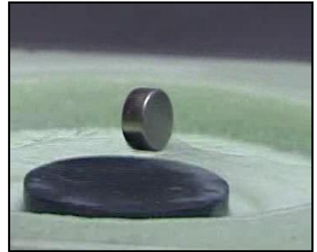
Schwebender Hochtemperatursupraleiter im Magnetfeld
