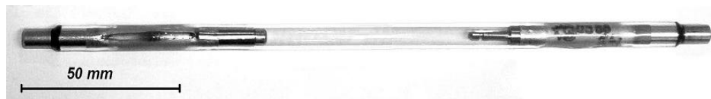
Gasentladungslampe ein Festkörperlaser mit Kryptonfüllung
