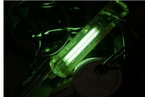
Mit Tritium gefüllte und mit ZnSiO 4 :Mn 2+ beschichtete Röhre
