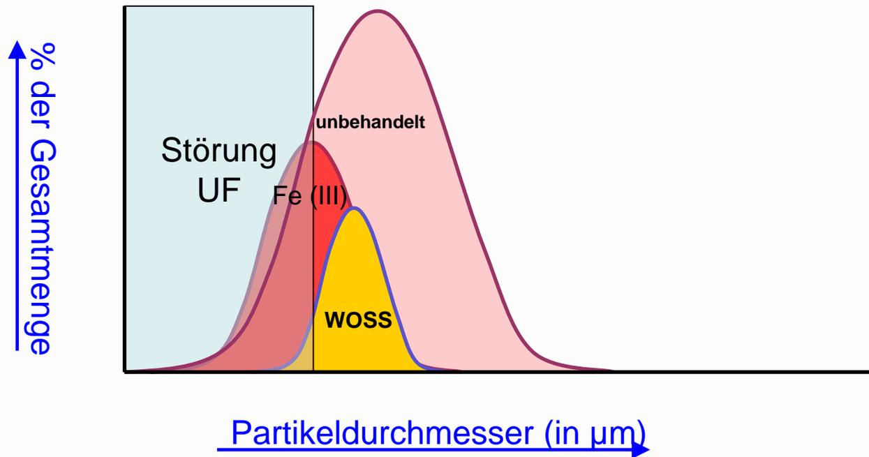
Durch bessere Auswahl von Flockungshilfsmitteln, sowie Verfahrenstechnische Änderungen, wird das UF Verfahren sicherer (weniger Verstopfung) und billiger (Kreislaufgeschwindigkeit).
