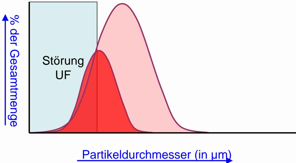
Flocke wird im UF-Kreislauf bei einer Strömungsgeschwindigkeit von 3,5 m/s völlig zerstört, somit erreichen wir ungefähr die gleiche Menge an feindispersierten Feststoffen wie am Anfang.
