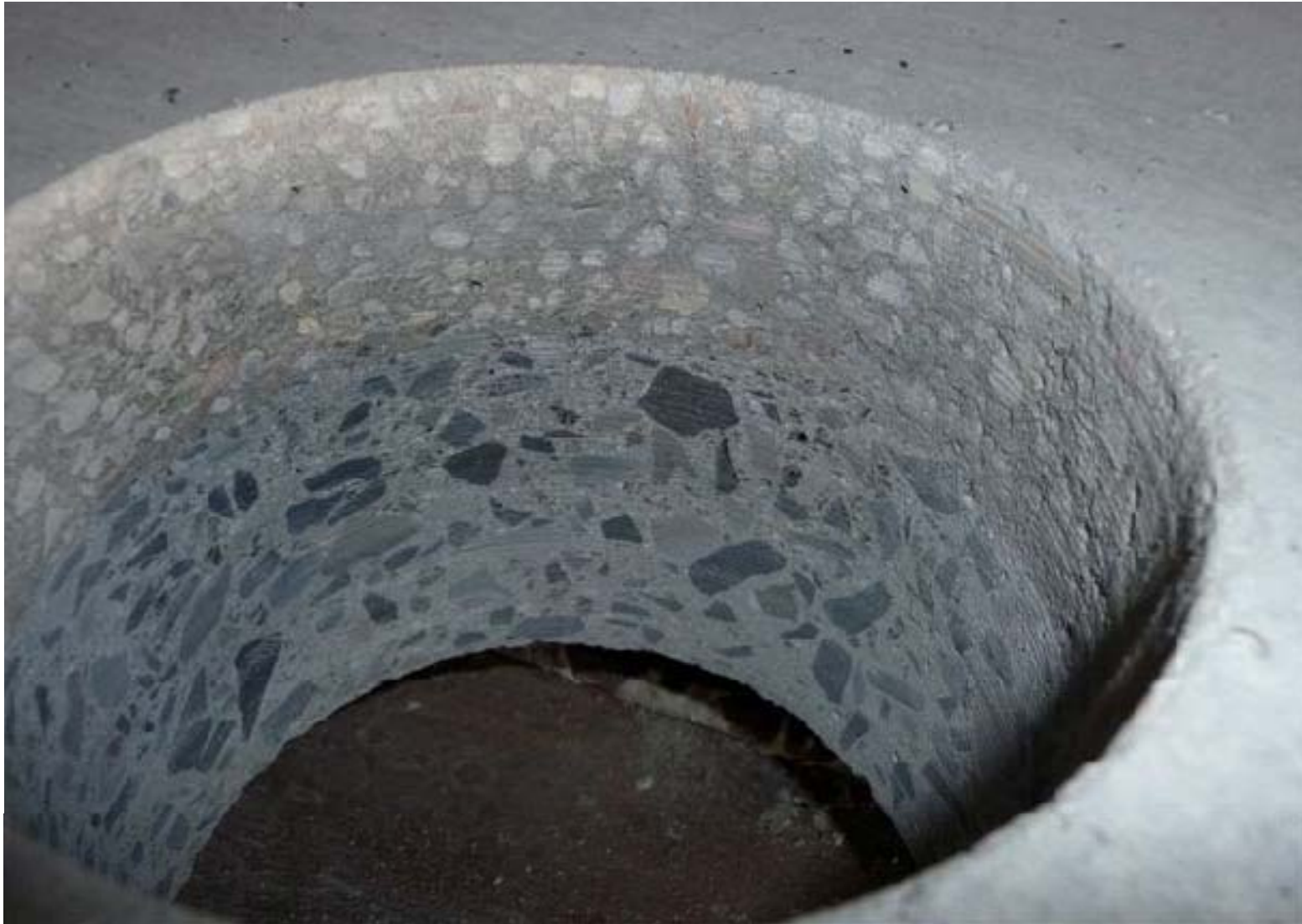
Betonfertigteile mit PCM, Probeguss Firma Kleihues
