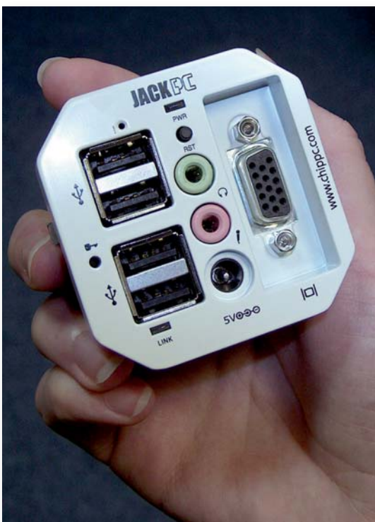
Abb. 12-1: Der Thin Client
