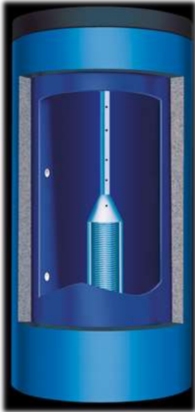
Pufferspeicher mit Solar-Wärmetauscher und Thermosiphonrohr
