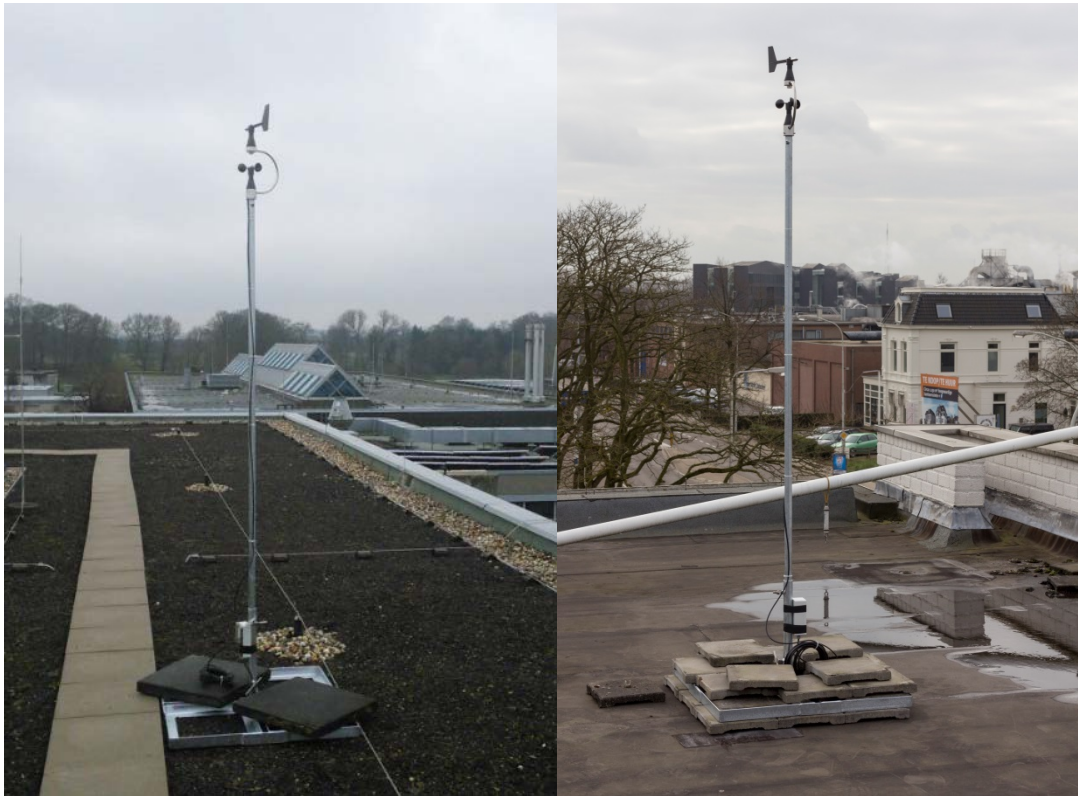
Afbeelding 3-1: Windmetingen op het dak van de hogeschool Münster (l.) en op het dak van de Regio Achterhoek (r.)
