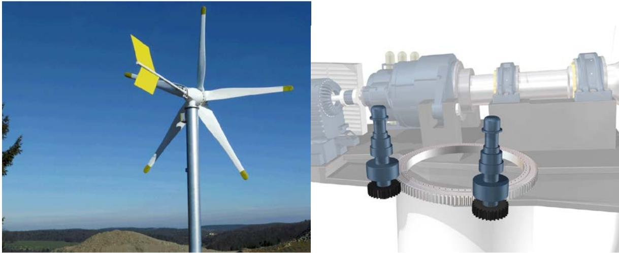
**Abbildung 2-2: Links: Windnachführung mit Windfahne (Quelle: Aldatec). Rechts: Windnachführung mit aktivem Antrieb (Quelle: Schaeffler)**
