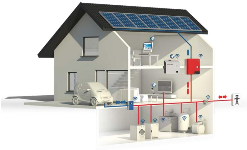
**Abbildung 4-1: Möglicher Aufbau eines Smart Home Systems [Quelle: SMA Solar Technology AG]**
