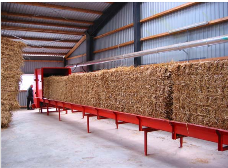
Abb. 4-4: Darstellung des Fördersystems
