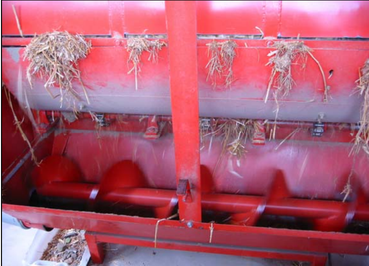
Abb. 4-5: Darstellung der Strohballenfräse
