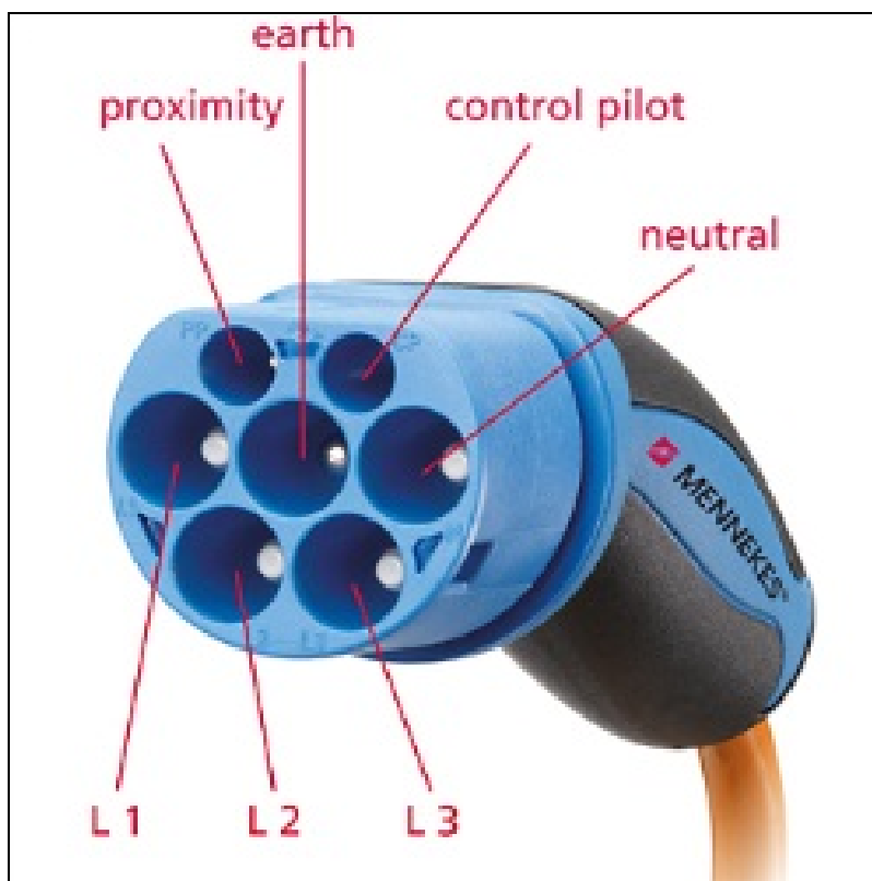
Abb. 3-6: Typ 2 Stecker Entwurf von Mennekes [16]
