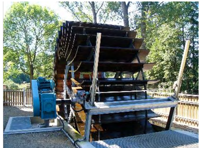
Abb. 1: Links: Bayerns ältestes Laufwasserkraftwerk mit drei Francisturbinen (Bildquelle: Richard Huber). Rechts: Unterschlächtiges Zuppinger Wasserrad (Bildquelle: Andreas Mühlbauer).
