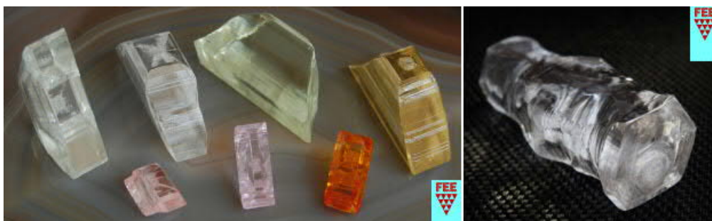
Abb. 1: KY(WO 4 ) 2 (KYW, links) Kristalle mit verschiedenen Dotierungen und Li 2 B 4 O 7 , gezüchtet mittels TSSG ("Top-Seeded Solution Growth") und Czochralski-Methoden
