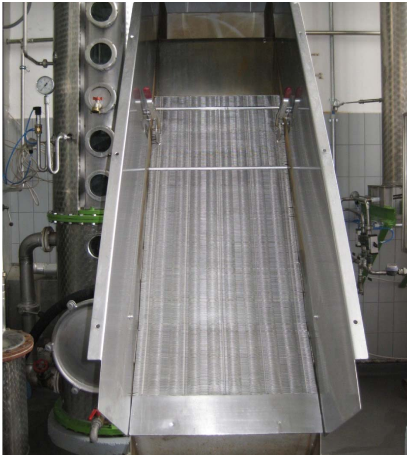
Abb. 10-10: Bogensieb der Forschungs- und Lehrbrennerei der Universität Hohenheim
