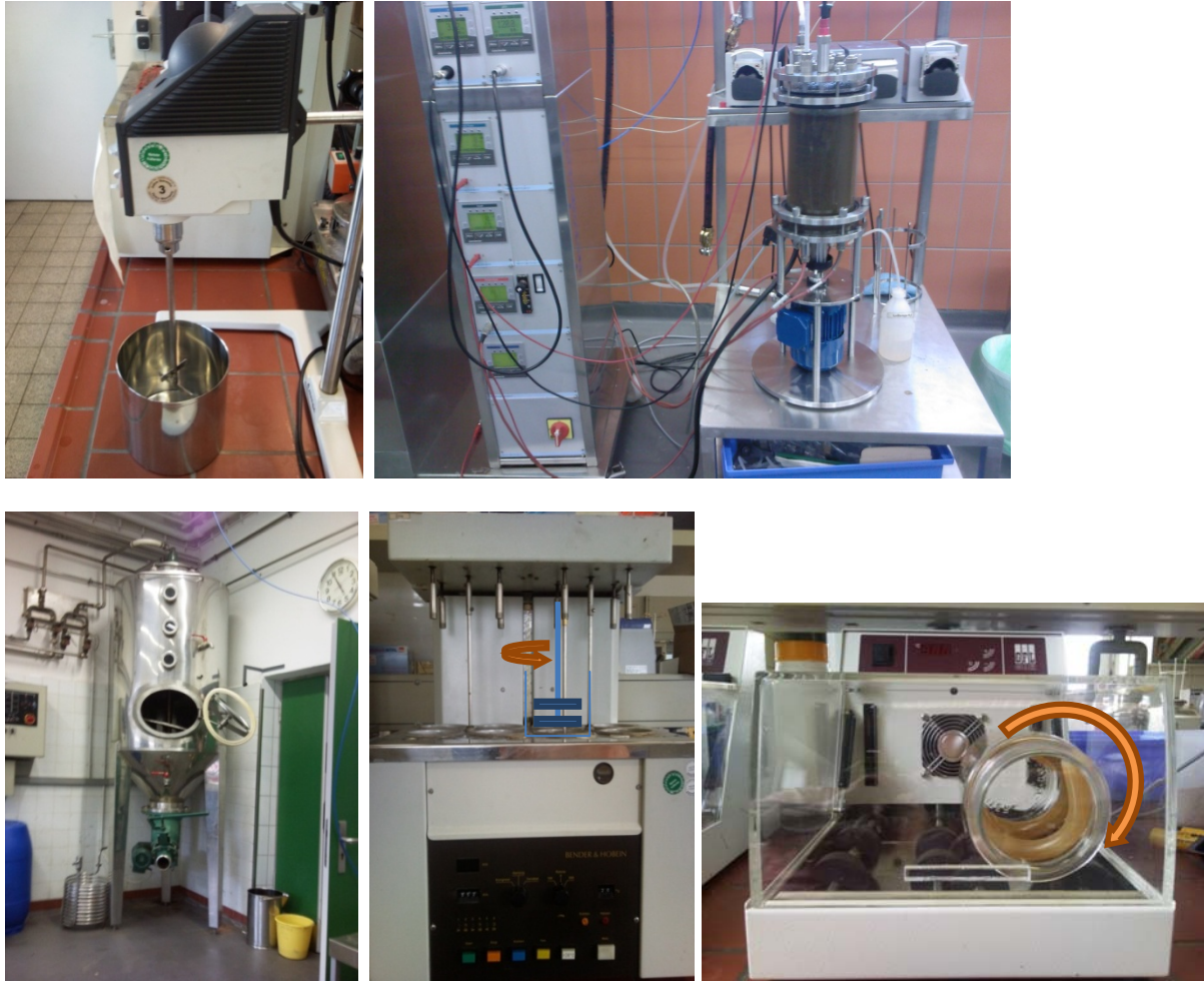
Abb. 5-1: Getestete Hydrolysebehälter: Laborrührwerk mit Blattrührer (o. l.), Laborfermenter (o. r.), Vinotherm (u. l.), Maischbad (u. m.), Rolleninkubator (u. r.)
