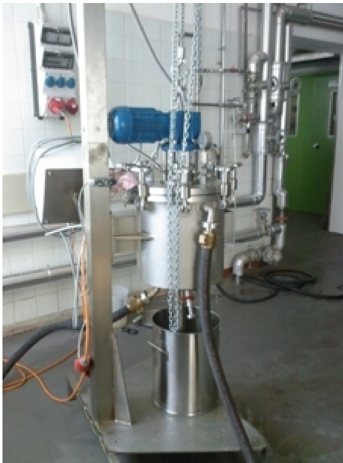
Abb. 4-15: Reaktor für Steam-explosion und Dämpfversuche
