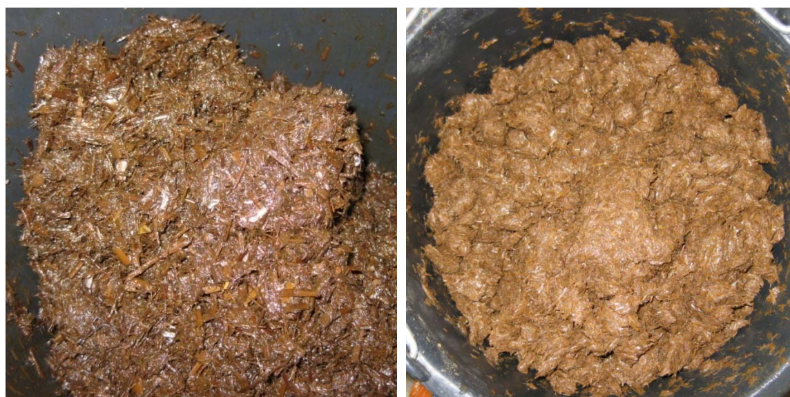
Abb. 10-13: Feste Fraktionen von fermentierter Maissilage (l.) und fermentiertem Stroh (r.) nach Siebung mit 1,52 mm Maschenweite
