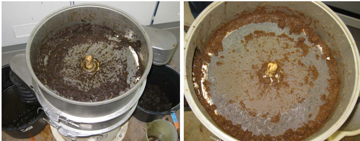
Abb. 10-14: Schwingsieb mit 0,3 mm Maschenweite nach der Separation von Maissilage (l.) und mit 1,52 mm Maschenweite nach der Separation von Stroh (r.)
