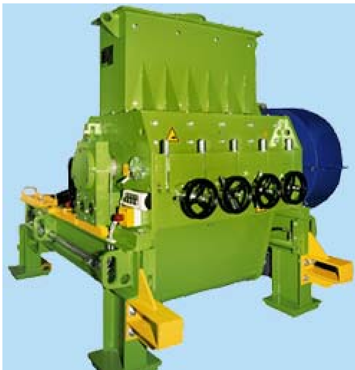
Abb. 4-2: Schneidmühle der Fa. MEWA [8]
