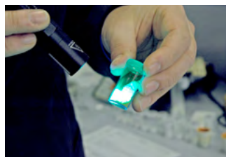
↳ Dieser grüne LED-Leuchtstoff wird an unserer Hochschule dazu verwendet, weiße LEDs herzustellen. Gemeinsam mit roten und blauen Leuchtstoffen bildet er den Farbraum des Lichts nach.
