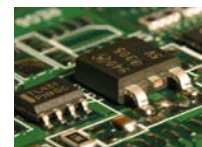
diverse SMD-Bauteile (SO8 und DPAK)
