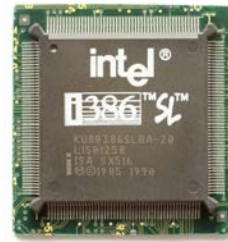
bumped TQFP132 beim Intel i386SL
