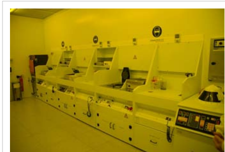
Rotationsbeschichtungsanlagen für den Photolackauftrag unter photochemisch unwirksamer Beleuchtung („Gelblicht“)
