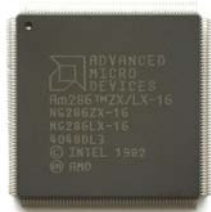
TQFP216 AMD Am286LX/ZX (SoC)
