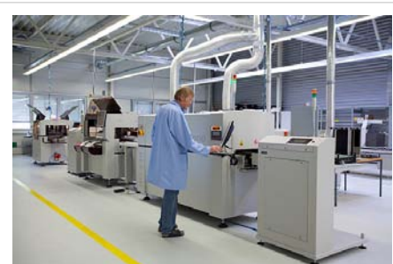
SMT-Bestückung und SMD-Löten mit Hilfe einer vollautomatischen SMD-Bestückungslinie
