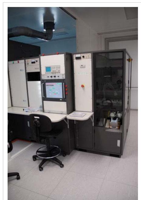
Ionenimplantation-Anlage zum Einbringen hochenergetischer Ionen in den Wafer, beispielsweise Sauerstoff bei der SIMOX-Technik (englisch: separation by implanted. oxygen, SIMOX ).
