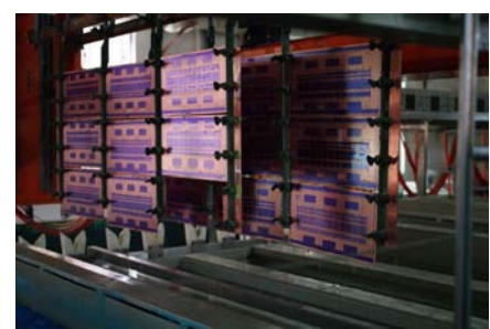
Leiterplatten während ihrer Elektroplattierung
