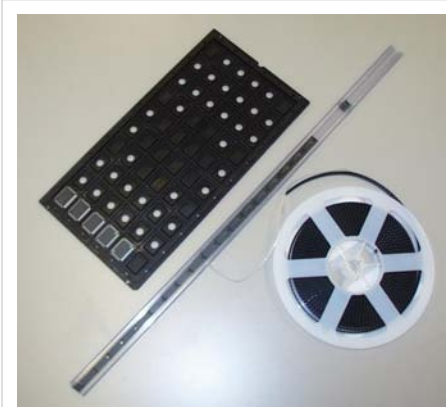
v. l. n. r. Bauteilverpackung in Tray, Tube und Tape/Reel
