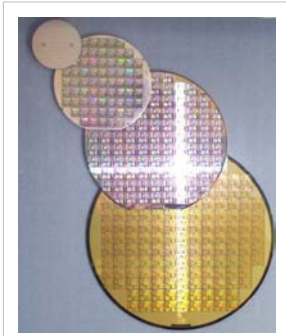
Wafer von 2 Zoll bis 8 Zoll mit bereits fertig produzierten Schaltungen
