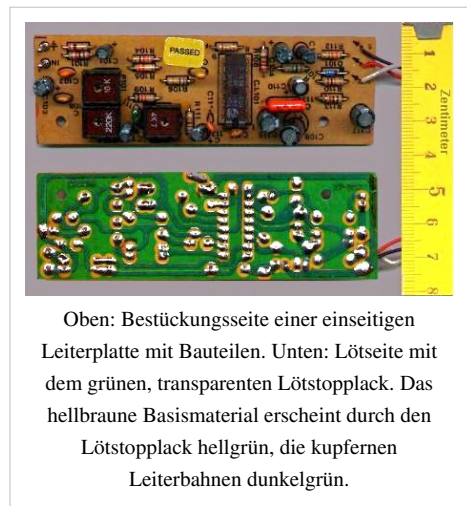
Oben: Bestückungsseite einer einseitigen Leiterplatte mit Bauteilen. Unten: Lötseite mit dem grünen, transparenten Lötstopplack. Das hellbraune Basismaterial erscheint durch den Lötstopplack hellgrün, die kupfernen Leiterbahnen dunkelgrün.
