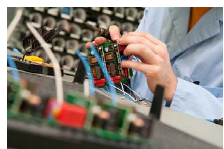
Handlöten von Kabeln und Leiterplattenverbindern
