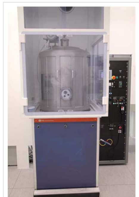
Beschichtungsanlage für das thermische Verdampfen von Metallen (Varian 3119)
