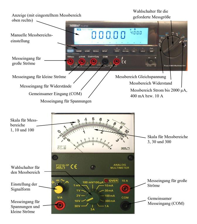
Das Gerät wird bei der Strommessung in Reihe in den Stromkreis geschaltet. Der Strom durchfließt dann nahezu ohne Widerstand das Messgerät. Achtung: Es kann dabei zur Zerstörung des Gerätes kommen! Es ist bei allen Multimetern ein weiterer Messeingang für relativ große Ströme über 0,3A zu finden, den man bei der Strommessung immer als erstes wählen sollte, wenn nicht bekannt ist, in welcher Größenordnung der zu erwartende Strom ist.
